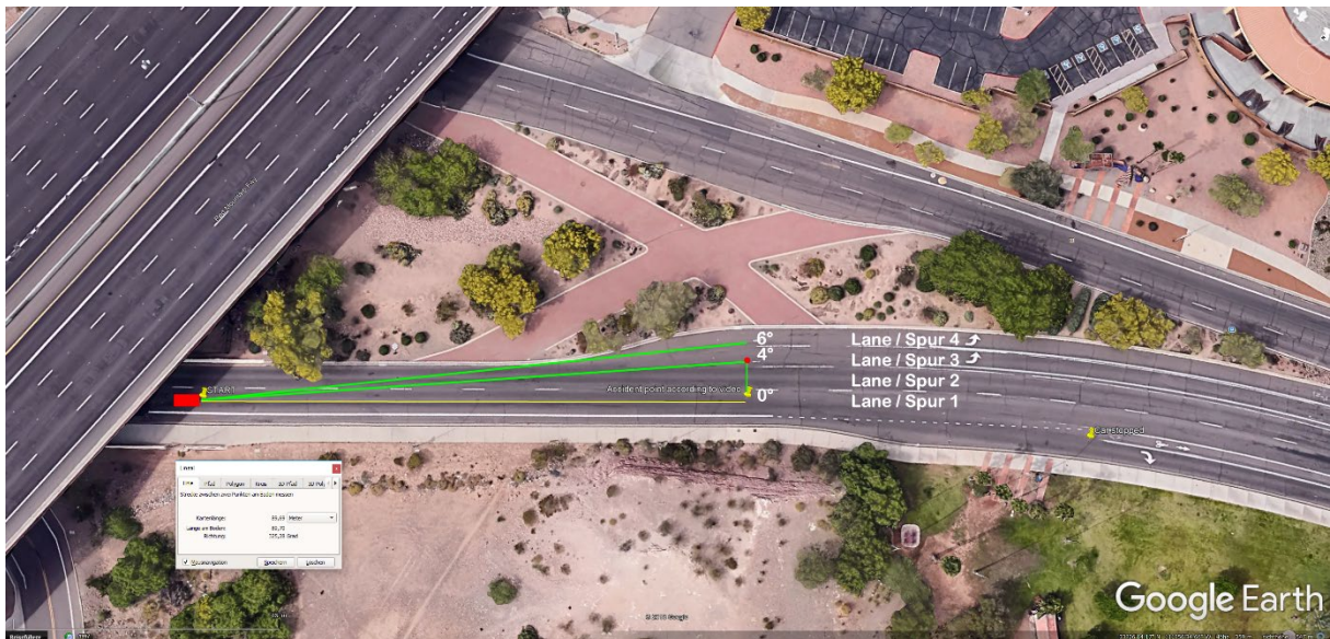
Abbildung 23: Ermittlung des Sichtwinkels
