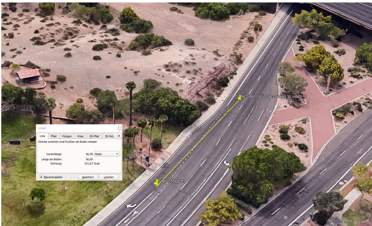
Abbildung 34: Ausmessen der Distanz zwischen Aufprall- und Auffindestelle
